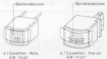
Bild 3 Bandkontaktflächen bei Cassetten-Köpfen
