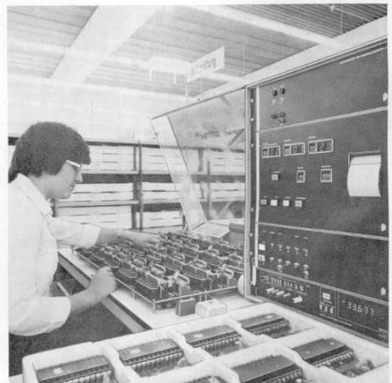
Bild 4 Driftmeßanlage bei geöffneter Abdeckung des Adapterrahmens
