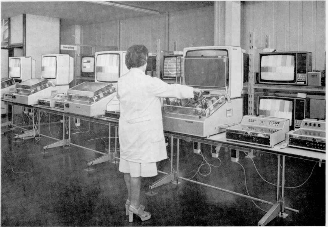
Bild 5 Dauerprüfanlage für Module mit Langzeitfehlern
