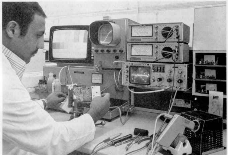
Bild 2 Reparaturplatz mit Kugelgelenkadapter (Farbbaustein)
