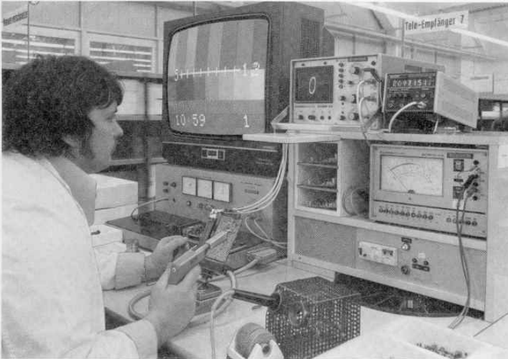
Bild 3 Reparaturplatz Uhrbaustein (Heizeinschub in Bildmitte)
